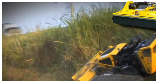
Exemple de fauche sur talus en pente avec girobroyeur télécommandé (largeur de coupe : 1,30m)
