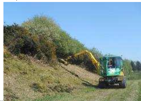
Exemple d'épareuse à bras déporté avec 15 m de portée horizontale
